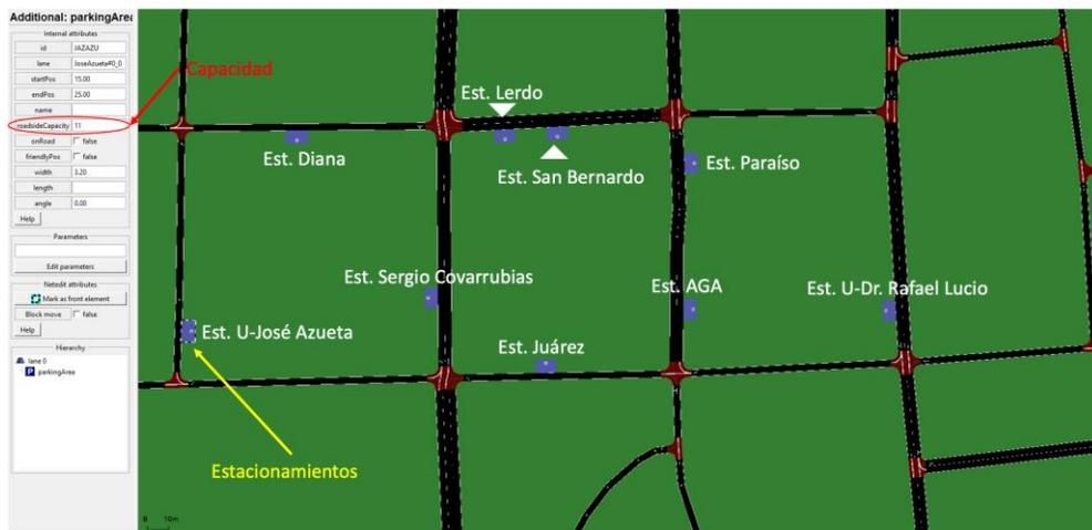
Figura 9. Configuración en SUMO de estacionamientos y sus capacidades.
